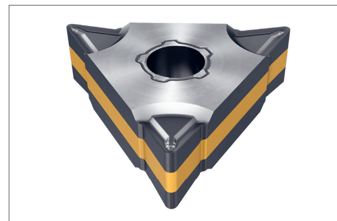
▲ Obr. 3: Nová trojúhelníková 55° destička D6NMG může ve většině případů nahradit standardní jednostrannou dvojbřitou destičku DCMT
